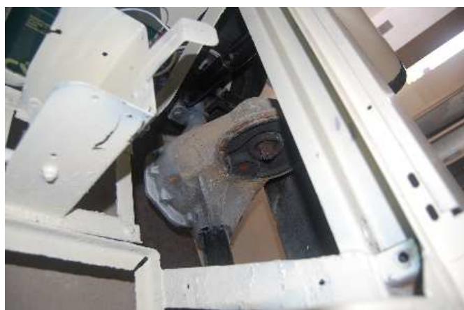
圖 2. 減速馬達直接固定在後輪之驅動軸上
