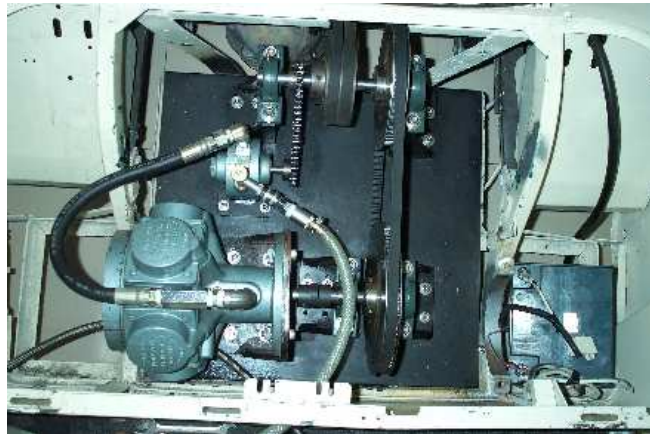
圖 5. 使用雙氣動馬達串連
