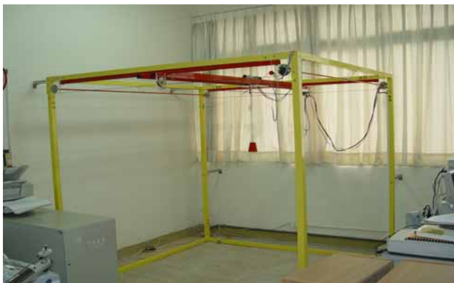
圖 1. 3D 天車實驗之機構圖
