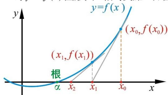
圖 2. 牛頓求根法
